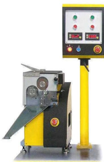
Настольный компактный гранулятор LZ-80 с переменной скоростью вращения двигателя от 0 до 1400 об/мин и режущим ротором с 6 ножами, выполненными из высококачественной углеродистой стали. Стабилизация скорости происходит при помощи программируемого преобразователя частоты. Защитная распахивающаяся крышка из поликарбоната снабжена замком безопасности, останавливающим двигатель при открытии.
