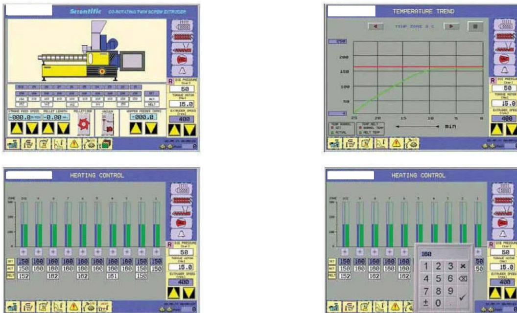
Автоматизированная компьютерная система управления включает полную визуализацию всех параметров экструдера на сенсорном экране, и имеет возможность присоединения к внешнему персональному компьютеру, на который могут быть загружены все программы и данные. Автоматизированное компьютерное управление PLC с 10.4 дюймовым цветным сенсорным экраном произведено Австрийской компанией B&R, и программное обеспечение разработано специально для двухшнековых экструдеров Labtech Engineering.
