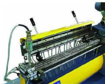
Цилиндр в сборе может легко распахиваться после ослабления фиксирующих винтов цилиндра. Это дает свободный доступ к шнекам для очистки или изменения шнековых элементов и/или вкладышей цилиндра, а также осмотреть расплав и получить визуальное представление о характеристиках обрабатываемого полимера.
