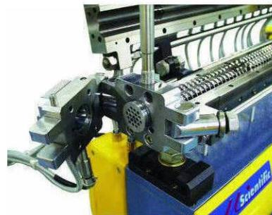
**Датчик давления** 0-100 бар в конце шнеков, также оборудован чувствительным датчиком температуры расплава и связан с цифровыми индикаторами на пульте управления.
