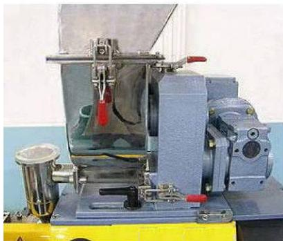
Стандартные экструдер оборудован **бункерным питателем** с объемным бункером из нержавеющей стали и «спиральным» бункерным шнеком, а также перемешивающей лопастью (мешалка) выше питающегося шнека. Бункерный питатель опционально также может быть оборудован двойными шнеками.
