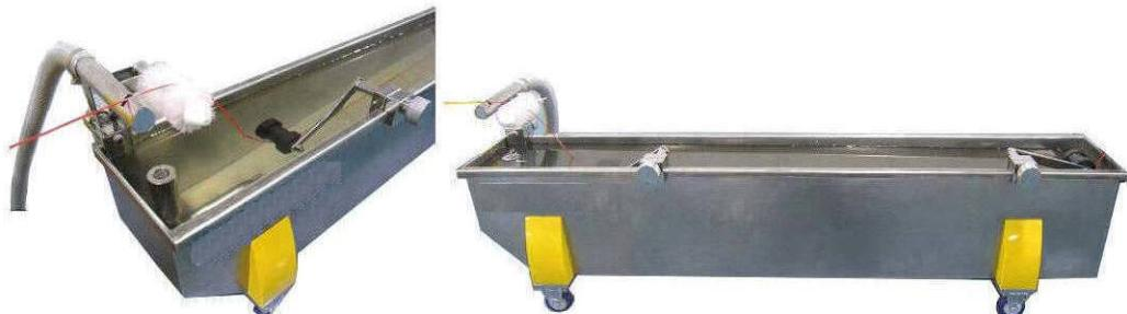
Настольная лабораторная охлаждающая водяная ванна LWB-40, изготовлена из нержавеющей стали и оборудована: двумя валками с двумя фиксируемыми на винтах валками, устанавливаемыми для продвижения стренги. Валки можно перемещать для достижения оптимальной эффективности охлаждения. Охлаждающая ванна оборудована всасывающей системой остатков воды со стренги. Вакуумное устройство сушки стренги находится строится в нижней стойке.
