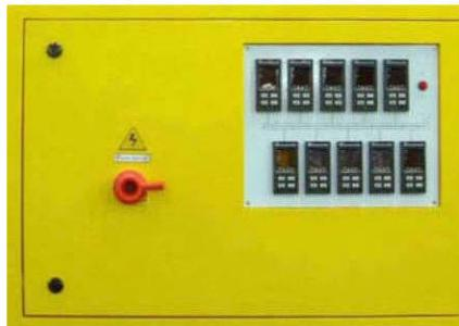
Дополнительный пульт управления установлен в нижней стойке корпуса экструдера, и содержит цифровые программируемые регуляторы температуры в зонах цилиндра, один для каждой зоны цилиндра и дополнительный регулятор для фильтры. 8 регуляторов для 32 L/D версии и 10 регуляторов для 40 L/D версии.
