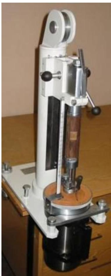
Прибор предназначен для определения наивысшей минусовой температуры, при которой консольно закрепленный и охлажденный образец, подвергнутый изгибу при ударе с постоянной скоростью, ломается или дает трещину.
